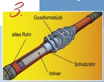
Gußformstücke verbinden die einzelnen Tube-In-Stränge und erlauben das Einbinden von Hausanschlüssen.
